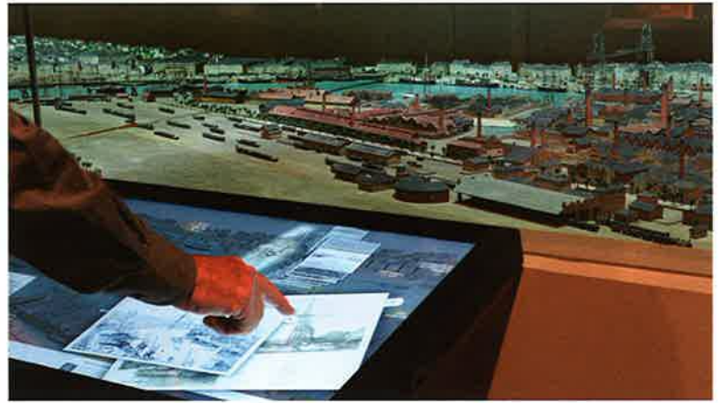
En cliquant sur l'une des trois dalles tactiles entourant la maquette de Nantes, le visiteur a accès à une base de connaissances évolutive et géolocalisée sur la maquette au moyen de quatre vidéoprojecteurs. © Château des Ducs de Bretagne
