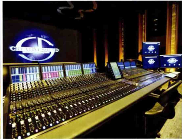
Gros plan sur la console Avid S6 M40 64, fader équipé des Post Module et Joystick Module, ainsi que d'une interface Avid/Dad MTRX.
